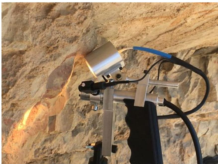
Figure II.12 : Prototype de dispositif portable de spectroscopie de réflectance diffuse (modèle développé par B. Schmitt, O. Brissaud (IPAG) et E. Malet) utilisé sur le site du Trou de la Féclaz (St Jean-d'Arvey). Photo E. Chalmin
