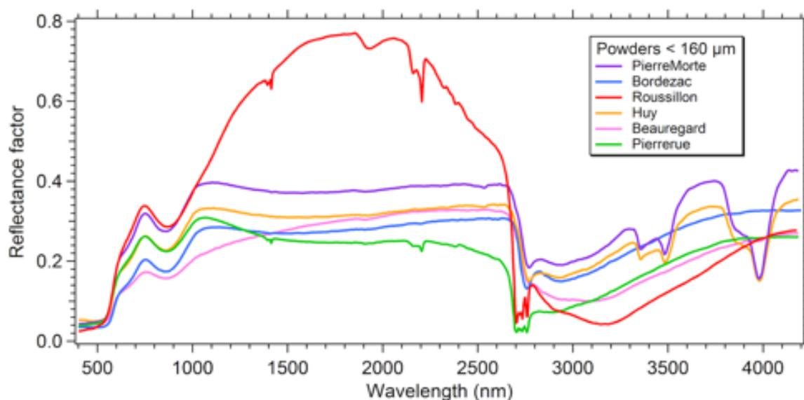
Figure II.6 : Spectres de réflectance Vis-NIR des poudres des 6 échantillons de référence : Pierremorte, Bordezac, Roussillon, Huy, Beauregard et Pierrerue (poudres de granulométrie < 160  $\mu\text{m}$ ) obtenus sur les dispositifs SHINE et SHADOW de l'IPAG.
