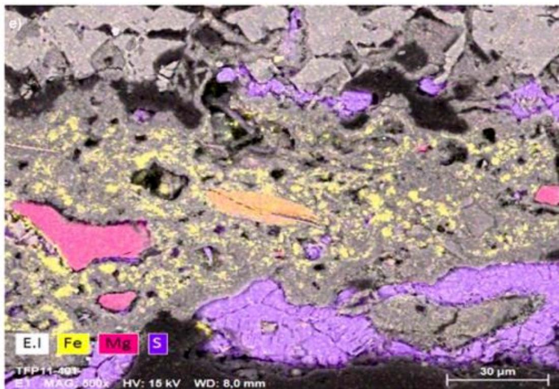
Figure III.18 : Image MEB-FEG (I. Néel) de l'échantillon TF\_P11\_401 (Trou de la Féclaz) : cartographie montrant la couche de matière picturale dispersée dans la matrice calcaire contenant des cristaux de dolomite (Mg) et de glauconite (Fe et Mg, orange) piégée entre deux couches de sulfate de calcium (S) dont une plus épaisse à l'extérieur (en bas) et déposée sur une couche de carbonate de calcium avec de larges cristaux géométriques (en haut) - S. Pairis
