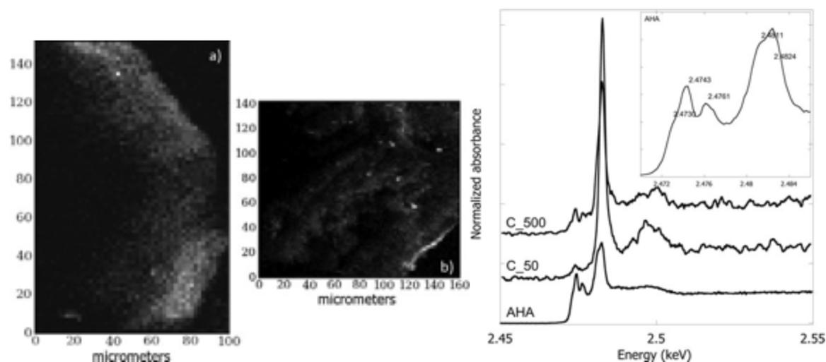
Figure V.1 : Échantillons synthétiques de calcite avec insertion d'acide humique Aldrich à différentes concentrations (C\_5, C\_50 et C\_500 respectivement : 5, 50 et 500 mg/L) : cartographie du S en micro-XRF (ID21, ESRF ; énergie: 2.1 keV, pixel : 2 x 2  $\mu\text{m}^2$ ) sur un cristal a) C\_50, b) C\_500 ; c) spectres XANES au seuil du S obtenus sur les cristaux C\_50 et C\_500, comparés au AH standard Aldrich (Chalmin et al. 2013)
