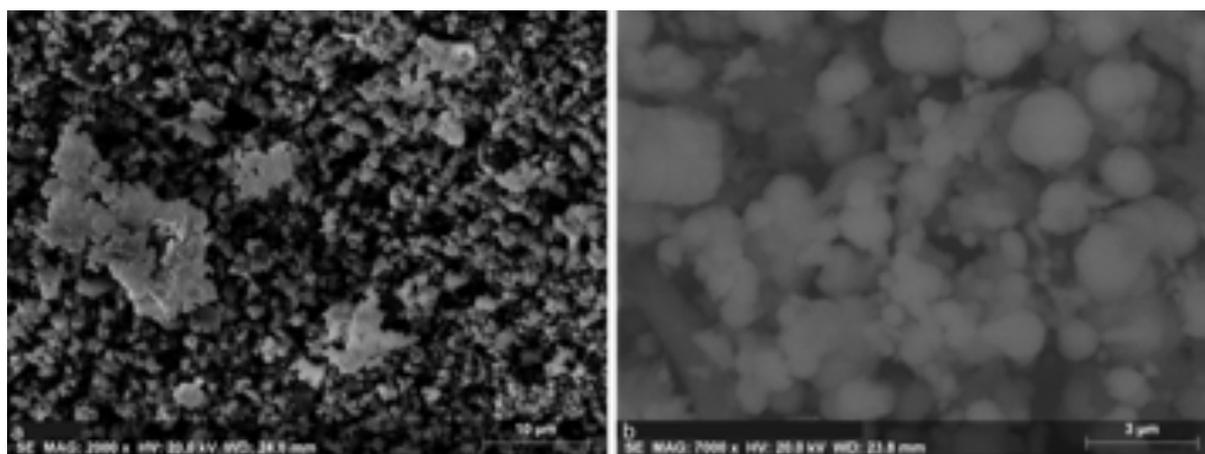
Figure III.14: Microphotographies MEB obtenues sur des vestiges (blocs non cohésifs) du Rocher du Château (Bessans) : a) morphologie de cristaux d'hématite et b) de sphérules d'apatite. A. Chassin de Kergommeaux
