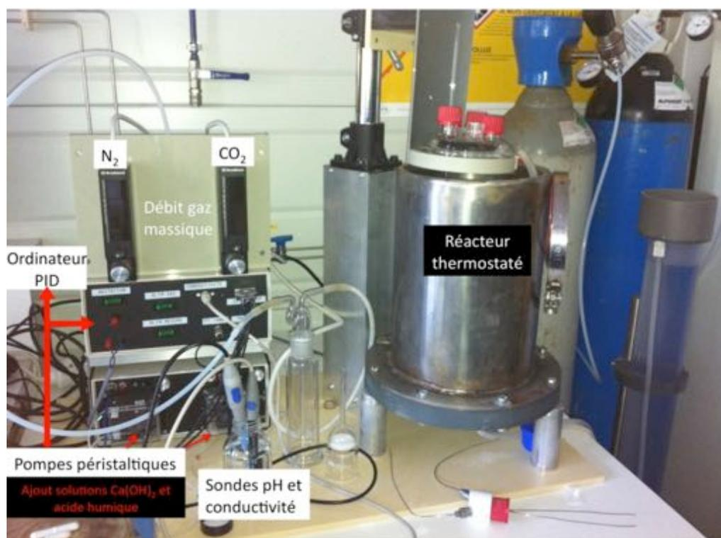
Figure V.2 : Montage de synthèse de calcite avec contrôle de la pression de CO<sub>2</sub>, pH, conductivité, température et débit. Photo E. Chalmin
