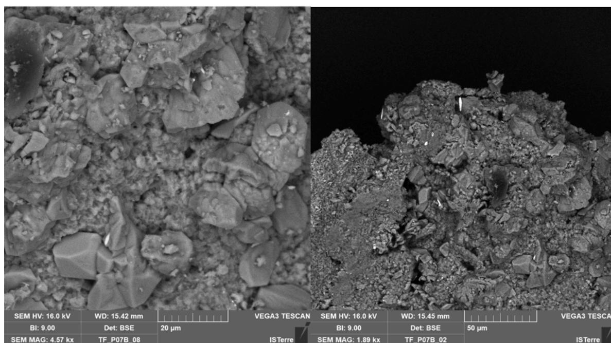
Figure III.17 : Observation de micro-prélèvements du Trou de la Féclaz au MEB-EDX (Tescan VEGA 3, Isterre) : (a) TF\_P05 (rouge clair) : observation de cristaux parallélépipédiques fracturés de sulfate de calcium. (b) TF\_P07B : enchevêtrement de baguette de sulfate de baryum. M. Le Turnier
