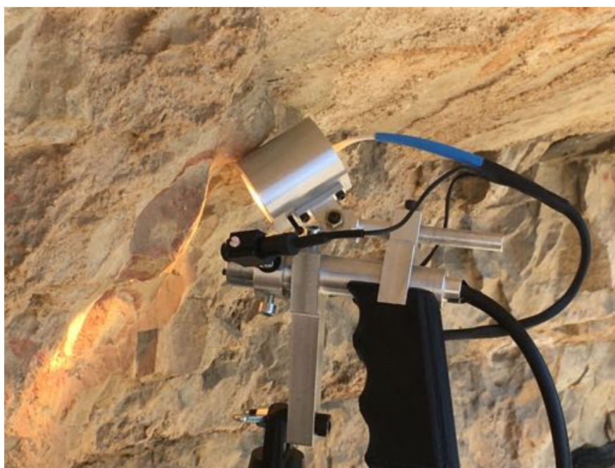
Figure II.12 : Prototype de dispositif portable de spectroscopie de réflectance diffuse (modèle développé par B. Schmitt, O. Brissaud (IPAG) et E. Malet) utilisé sur le site du Trou de la Féclaz (St Jean-d'Arvey). Photo E. Chalmin
