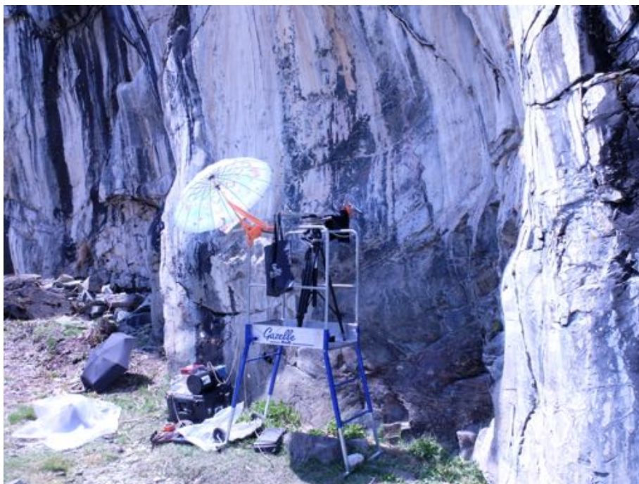
Figure II.11 : Photographie du dispositif Raman portable (laboratoire MONARIS) devant la paroi du panneau des cerfs du site néolithique du Rocher du Château (1750 m d'altitude, Bessans) illustrant les contraintes liées à l'ensoleillement, au manque de stabilité de la mesure en raison du vent, à la hauteur des figures nécessitant un échafaudage, à l'utilisation d'un groupe électrogène respectant les contraintes d'un parc naturel (bruit, émanation d'essence, ...). Photo E. Chalmin
